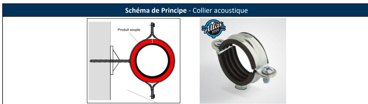
Figure 34 : Schéma de Principe - Collier acoustique
